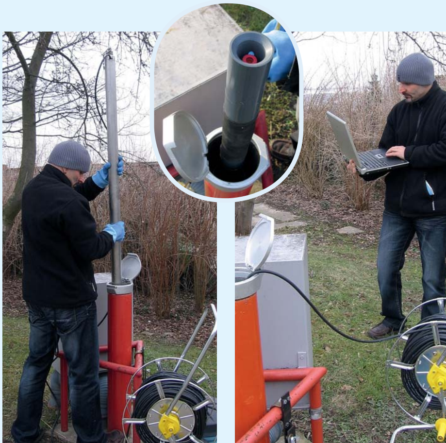
HANDHABUNG: Die GWMon-Station wird in der Messstelle installiert (oben), das GW-Shuttle eingefahren (links) und die Probenahme drahtlos per Notebook gesteuert (rechts) Foto: DGFZ
